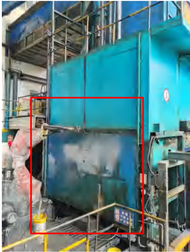
振动成型机（工作时正面及侧边密封）
